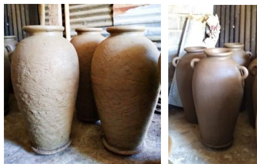
Gambar 2. Debil Sebelum dan Sesudah Pemasangan Telinge
